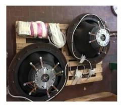
Ciascun prototipo (Fig. 1) prevede una stella costituita da elementi di piezoquarzo incollati su lamine di acciaio armonico. Ogni elemento presenta da un lato un vincolo tipo "incastro" funzionale per il trasferimento dei moti vibratori provenienti dal carrello ferroviario, dall'altro la massa di tuning necessariaper determinare una risonanza dello stesso in corrispondenza delle frequenze dei moti indotti.
