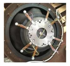
L'attività fornirà come report finale di testing la vita utile del dispositivo di recupero energetico integrato, intendendo per vita utile il numero di cicli raggiunto per ciascuna prova in corrispondenza dei primi fenomeni di deterioramento del sistema di recupero energetico, che vanno a compromettere l'incollaggiodei piezoquarzi.
