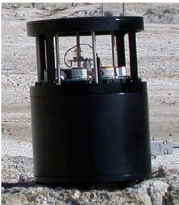
Naso elettronico ENEA utilizzato, nel cratere della Solfatara (NA), per il monitoraggio delle emissioni geochimiche rilevanti per la sorveglianza di quella area vulcanica
